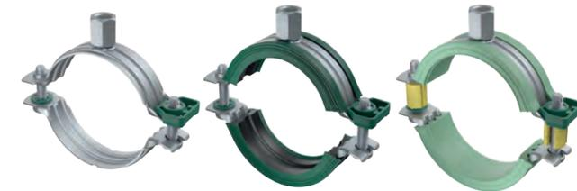
Die Bifix® 5000 Schelle wurde vor allem zur Befestigung von Kunststoffrohren entwickelt. Insbesondere die spezielle Gummieinlage sowie Distanzringe ermöglichen ein hervorragendes Gleiten des Rohres in der Schelle bei thermisch bedingten Längenänderungen.
